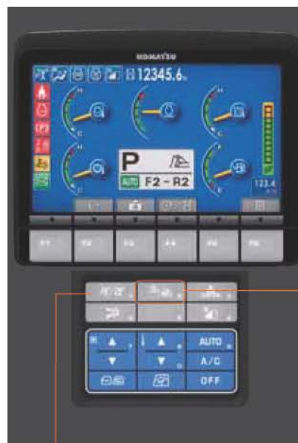
運転モード切り換えスイッチ
